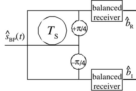
Fig. 3 DQPSK direct detection receiver
